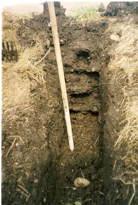
Figura 2. Detalle de la calicata de la pila mayor (Fig.1) (extractor de muestras en la parte superior izquierda de la figura) tras la extracción de 2 muestras c/10 cm).
